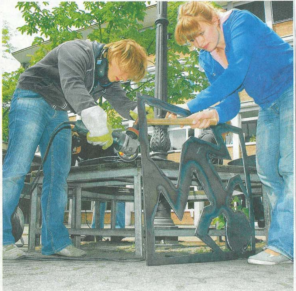
Mit Winkelschleifer und Feile wurden die Eisen-Objekte nachbearbeitet. Die beim Schweißen entstandene schillernde Färbung verschwindet, wenn die Kunst im Freien aufgestellt wird und dabei Rost ansetzt. BILD: RÖS
